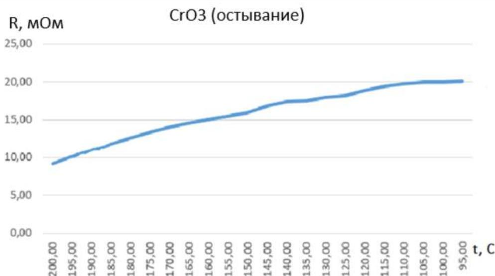
Рисунок 2 - График  $R(t)$  для  $\text{CrO}_3/\text{CrO}_2$  при остывании
