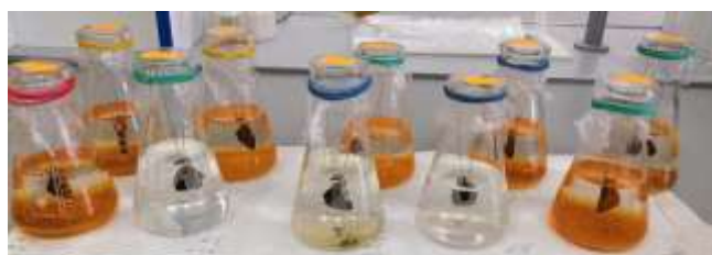
Рис 1. Пластины 1-10 (счёт с левой верхней колбы до правой нижней) через 3 недели после начала исследования (после коррозии)
